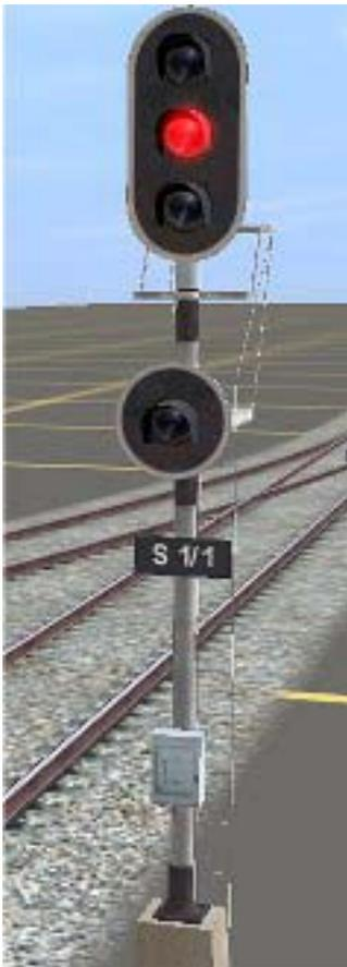
El primero de ellos son las **señales compatibles con el sistema ASFA**. Estos objetos de señalización, generalmente señales luminosas, aunque el sistema está diseñado para soportar otros tipos como las mecánicas, son la base fundamental del sistema. Dependiendo del estado de dichas señales el sistema tendrá una u otra reacción de supervisión.
