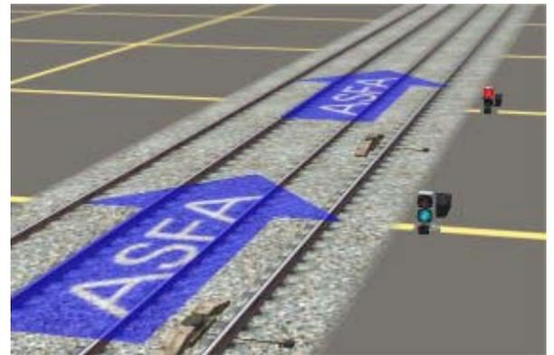
f) Señales de maniobra de cuatro focos: se suelen emplear en las estaciones para señalar las vías de servicio o en los cambios de agujas como *señales de retroceso* para señalar los tramos de contravía en los cambios. Tienen la particularidad de mostrar la **posición de los desvíos** (si los hubiese) al igual que las señales avanzadas comentadas en c) anteriormente. Pueden mostrar los siguientes aspectos:
