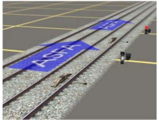
e) Señales de salida de dos focos: se emplean como señales de salida de las vías de servicio de estaciones y pueden mostrar los siguientes aspectos:
