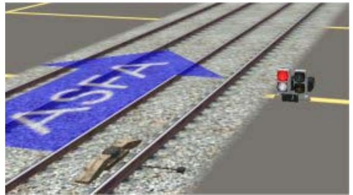
Al igual que las anteriores la posición de los focos es simétrica con respecto al lado de instalación de la señal. El aspecto de rebase coincide con el que mostraría una señal de maniobra de cuatro focos como la comentada en f) anteriormente.
